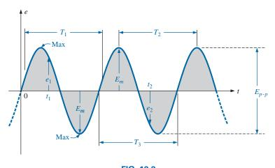
**FIG. 13.3** *Important parameters for a sinusoidal voltage.*
